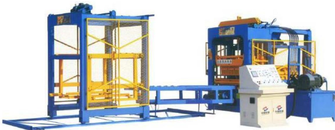
图 2-4 一体化自动免烧砖成型机
