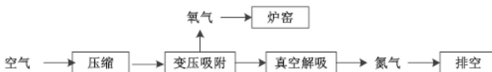
图 2-2 压缩空气制备工艺流程图
